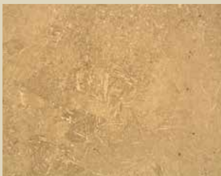
Figura 02B - DIN 1.2738 - Microestrutura temperada e revenida - região do núcleo.
