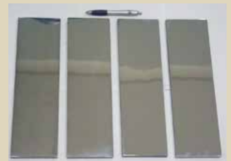
FiFigura 04 - Amostras polidas (Transversal e Longitudinal) - DIN 1.2311 e DIN 1.2738 Amostras com dimensões 100 x 345 x 12mm
