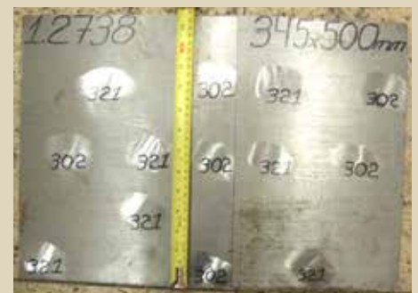
Figura 01B - DIN 1.2738 - Valores de dureza encontrados na secção transversal 302-321 HB
