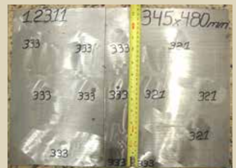
Figura 01A - DIN 1.2311 - valores de dureza encontrados na secção transversal - 321-333HB.
