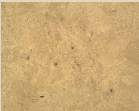
Figura 02A - DIN 1.2311 - Microestrutura temperada e revenida - região do núcleo.
